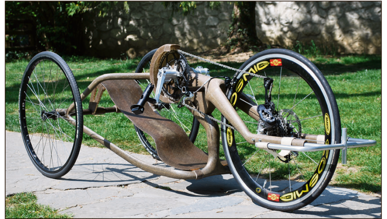
Le matériau principal du biobike , la fibre de lin, est environ trois fois moins résistant et environ cinq fois moins rigide que le carbone.
