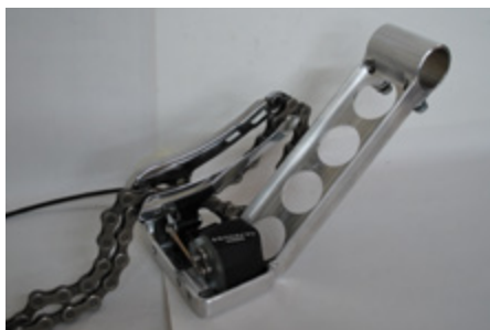
À la poursuite du gramme de trop! (Le support de l'actionneur du dérailleur)
