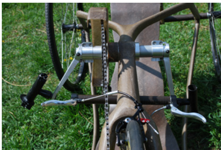
Le pédalier extensible en configuration de virage à tribord
